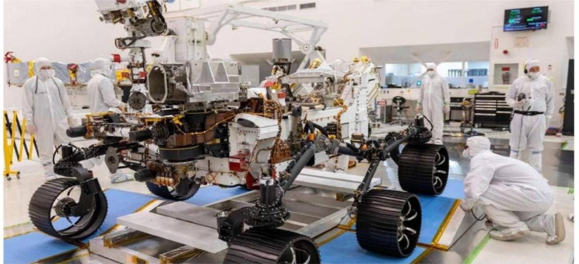
Perseverance tem o tamanho de um carro (3 metros de comprimento por 2,70m de largura) e seis rodas.
